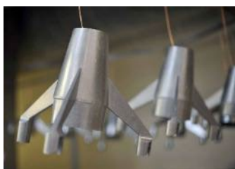
丁寧な下処理の後、塗装オープンに運ばれるアルミダイキャスト部材。
