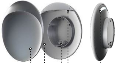
フロントシェル・ハウジング部：アルミダイキャスト LED光源 電源ケーブル穴 後部スリット：射出形成アクリル
